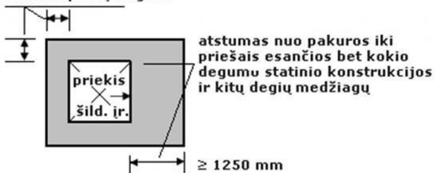
6 paveikslas. Atstumo tarp šildymo įrenginio ir statinio konstrukcijos ir kitų degių medžiagų nustatymo principas
